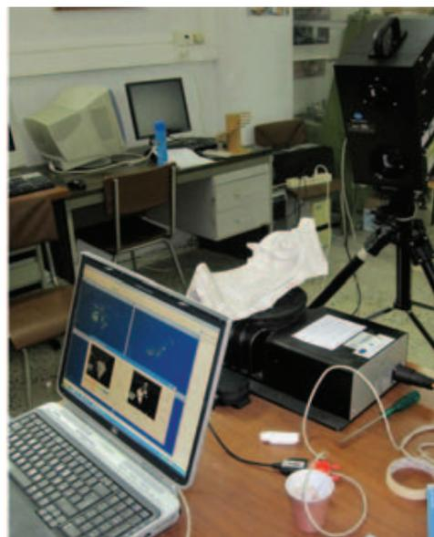
Fig. 5: Acquisizione della forma geometrica di un modello in gesso riprodotto una porzione d'angolo di un capitello composto. Applicazione della tecnica di rilevamento laser scanner a triangolazione.
